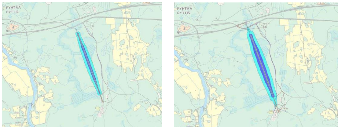
Kuva 17. Lentopaikan melumallinnuksen oteet lentomäärille 50 lento / vrk ja 100 lentoa / vrk. Alue, jolla L Aeq (7-22) 50 dB raja ylittyy, on vaalean sininen.
