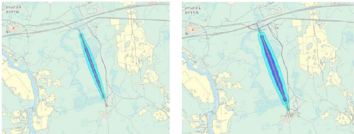
Kuva 8. Lentopaikan melumallinnuksen otteet lentomäärille 50 lento / vrk ja 100 lento / vrk. Alue, jolla LAeq (7-22) 50 dB raja ylittyy, on vaalean sininen.
